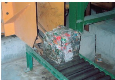
Εικ. 7.9 Διαχωρισμός αλουμινίου σε εργοστάσιο μηχανικής διαλογής
