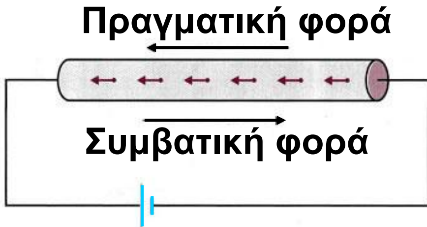
Εικ. 2.2-4. Φορά του ηλεκτρικού ρεύματος.
