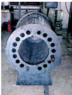
ΣΧ. 4.3γ Χαλύβδινος λέβητας κεντρικής θέρμανσης, σε δυο φάσεις κατασκευής τους. Αριστερά διακρίνονται οι οπές εισαγωγής των τούμπων.
