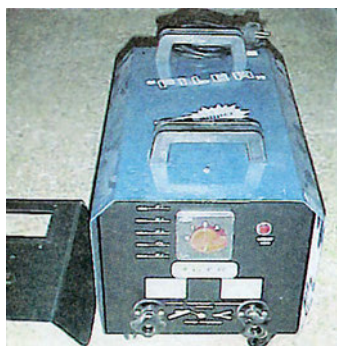
ΣΧ. 1.9κθ Ηλεκτροκόλληση.
