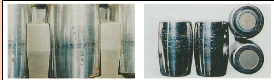
Σχήμα 1.182 (α) Rust & corrosion - Οξείδωση, (β) Scoring - Σκωρίαση
