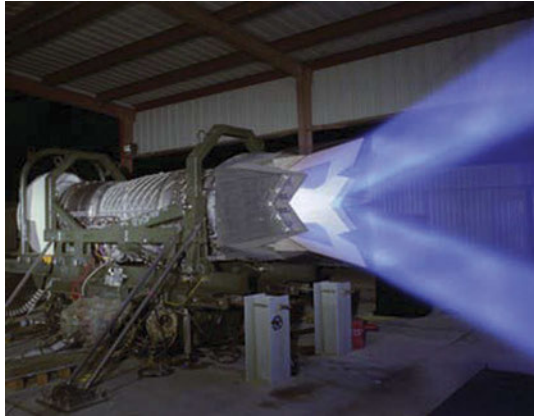
Σχήμα 2.96 Ακροφύσιο με μεταβλητή διεύθυνση εξαγωγής καυσαερίων (A/K F119 της P&W)
