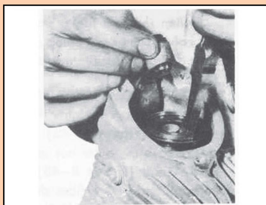
Σχήμα 1.187 Αφαίρεση ροδελών με τανάλια
