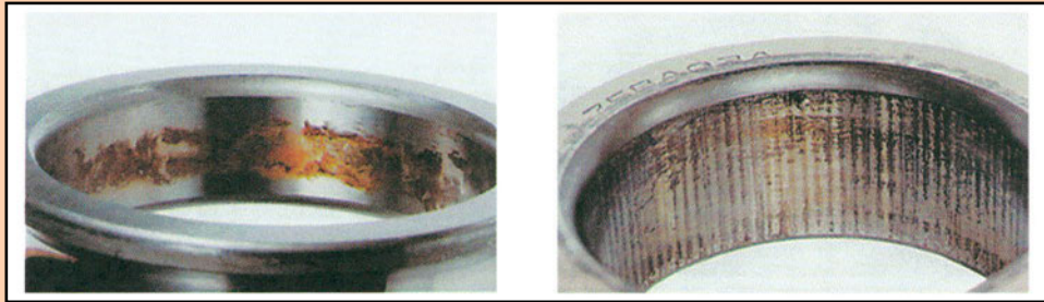
Σχήμα 1.180 Fretting - Φθορά από τριβή
