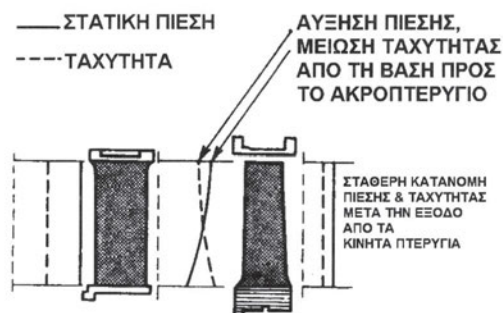
Σχήμα 2.86 Κατανομές των μεγεθών στις βαθμίδες στροβίλου συνδυασμένης γεωμετρίας
