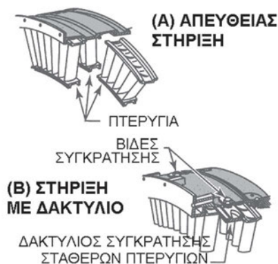
Σχήμα 2.58 Σταθερά πτερύγια συμπιεστή
