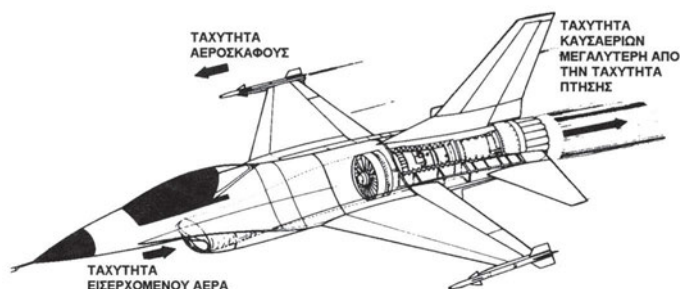
Σχήμα 2.12 Η ταχύτητα των εξερχόμενων καυσαερίων είναι μεγαλύτερη από την ταχύτητα πτήσης του αεροσκάφους
