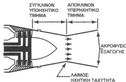
Σχήμα 2.94 Συγκλίνον-αποκλίνον ακροφύσιο
