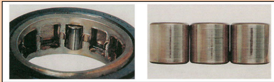
Σχήμα 1.176 (α) Cage deformation - Παραμόρφωση κλωβού, (γ) False brinelling - Χαρακτηριστική φθορά εδράνων κύλισης
