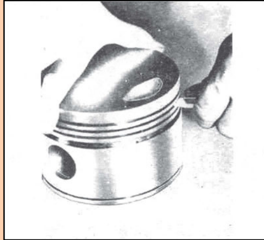
Σχήμα 1.195 Καθαρισμός περιοχής δακτυλίων
