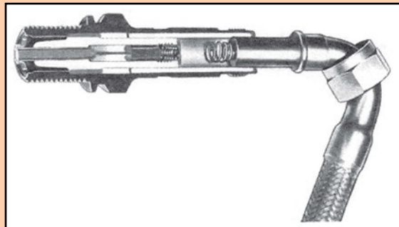
Σχήμα 1.212 Σωστή τοποθέτηση ακροδέκτη
