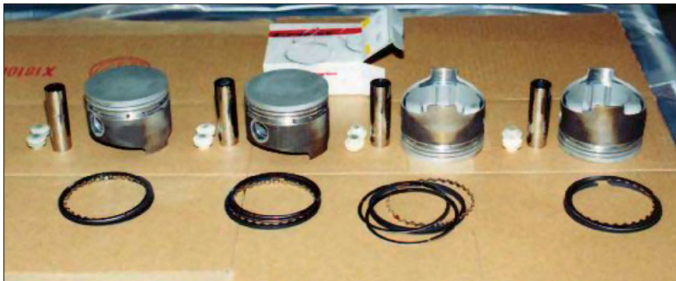
Σχήμα 2.19 Αντιστοίχιση εμβόλων και δακτυλίων
