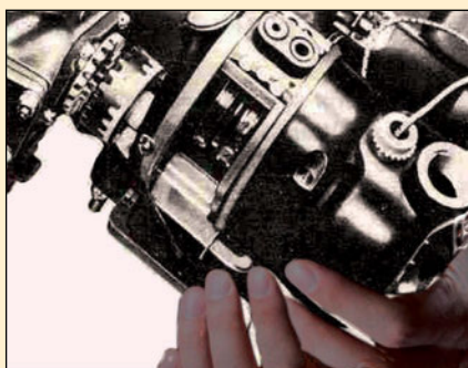
Σχήμα 2.126 Ρύθμιση του αντικραδασμικού συνδέσμου
