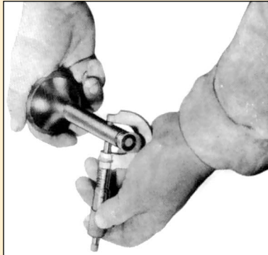
Σχήμα 2.99 Μέτρηση διαμέτρου σε στέλεχος βαλβίδας
