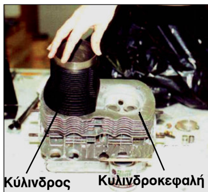
Σχήμα 2.18 Προσαρμογή κυλίνδρου σε κυλινδροκεφαλή
