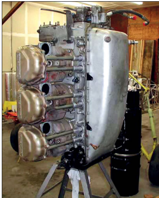
Σχήμα 2.9 Κινητήρας O-470 σε κλίση αποσυναρμολόγησης
