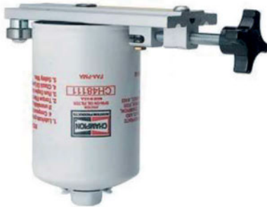
Σχήμα 2.6 Καταστροφικός έλεγχος φίλτρου ελαίου
