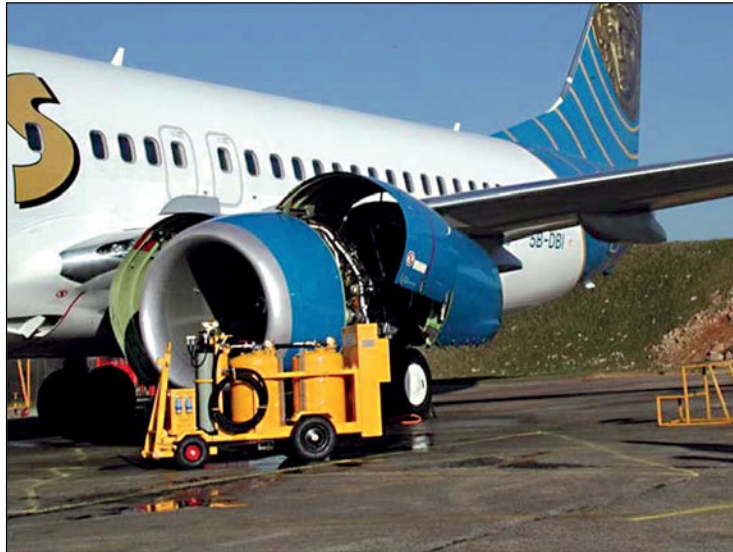
Σχήμα 3.3 Εξοπλισμός καθαρισμού κινητήρα
