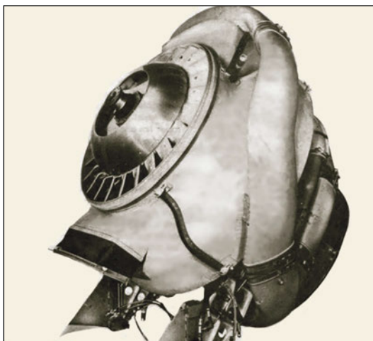
Σχήμα 2.43 Σύστημα ψύξης ακτινικού εμβολοφόρου κινητήρα ελικοπτέρου
