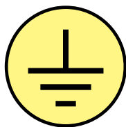
Σχήμα 2.31 Σύμβολο γείωσης που χρησιμοποιείται για τη σήμανση των σημείων γείωσης σε δάπεδο υποστέγου και πίστα
