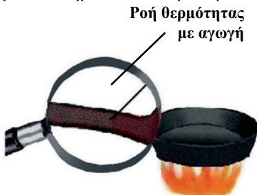
Σχήμα 1.8 Η θέρμανση της λαβής γίνεται μέσω «αγωγής»
