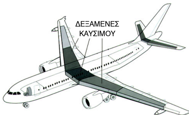
Σχήμα 3.35 Θέση δεξαμενών καυσίμου αεροσκάφους
