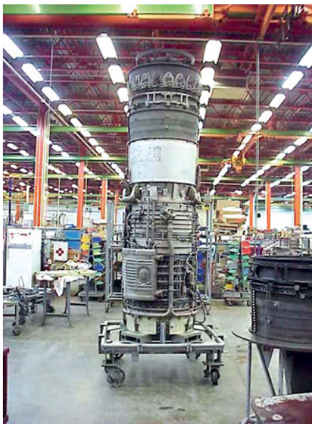
Σχήμα 3.6 Κινητήρας J79 στην κλίση αποσυναρμολόγησης
