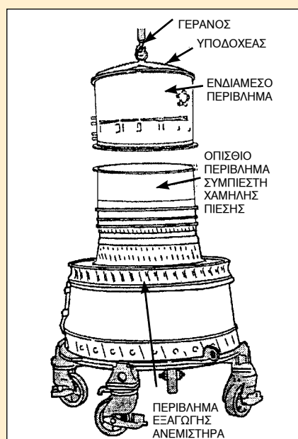
Σχήμα 3.98 Τοποθέτηση (α) σταθερών πτερυγίων, (β) οπίσθιου περιβλήματος συμπίεστη χαμηλής πίεσης, (γ) ενδιάμεσου περιβλήματος
