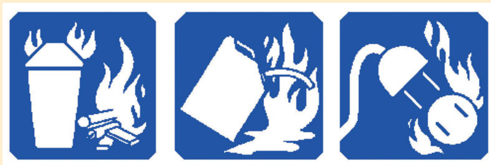
Σχήμα 2.55 Σήμανση πυροσβεστήρα κατάλληλου για πυρκαγιές τύπου A,B,C
