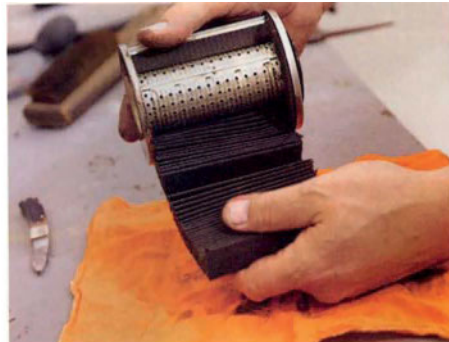
Σχήμα 2.6 Καταστροφικός έλεγχος φίλτρου ελαίου
