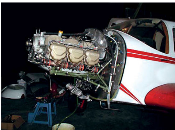
Σχήμα 2.8 Κινητήρας πριν την αφαίρεση από το α/φος
