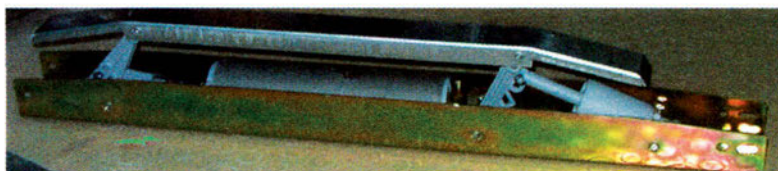
Σχέδιο 3.13 Μηχανισμός απομανδάλωσης ανοιγόμενης θύρας ανελκυστήρα
