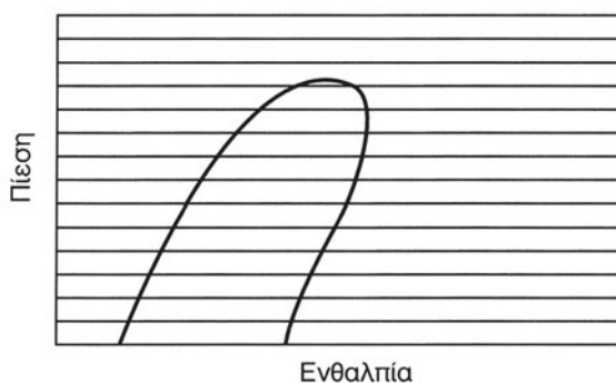
Σχήμα 6.26 Γραμμές σταθερής πίεσης
