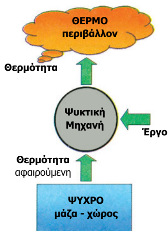
Σχήμα 1.5. Η αρχή λειτουργίας των ψυκτικών διατάξεων
