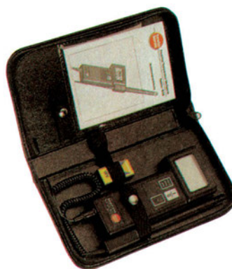
Εικόνα 10.1 Σύγχρονο ψηφιακό πολύμετρο θερμοκρασίας-υγρασίας χώρων
