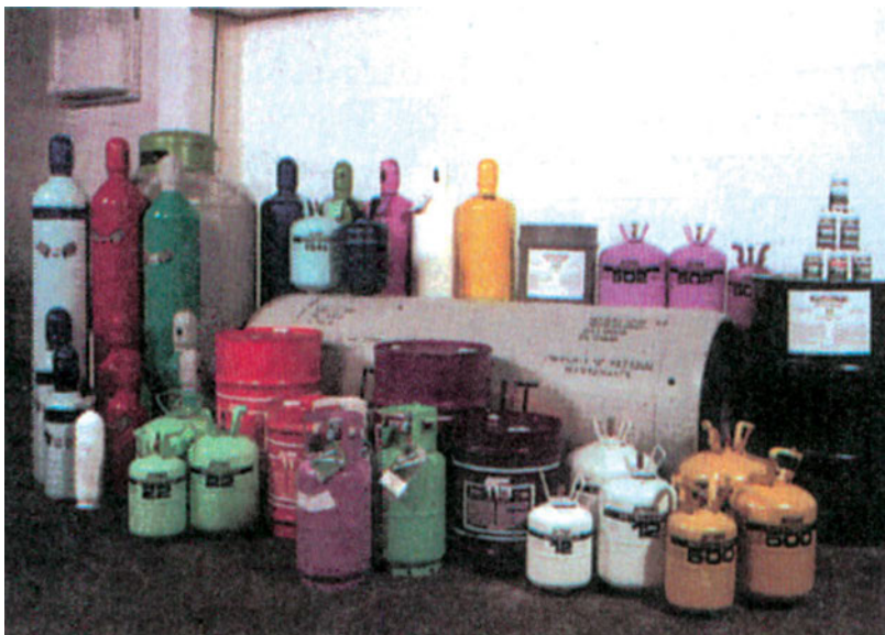
Εικόνα 6.21 Κύλινδροι αποθήκευσης ψυκτικών μέσων
