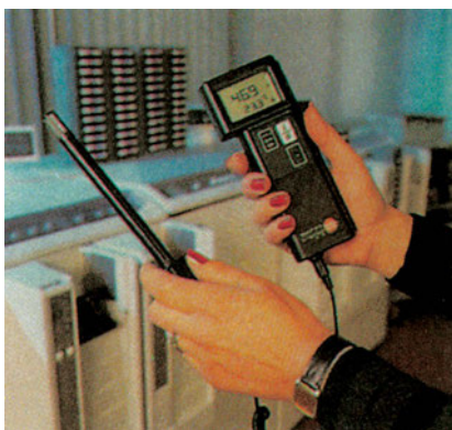
Εικόνα 10.1 Σύγχρονο ψηφιακό πολύμετρο θερμοκρασίας-υγρασίας χώρων
