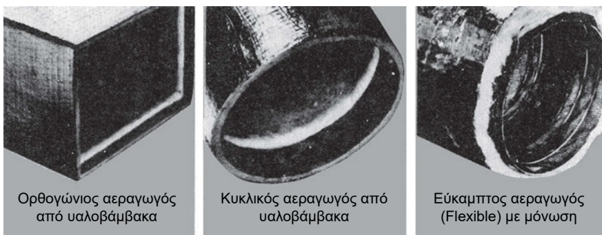
Εικόνα 12.4. Διατομές αεραγωγών από υαλοβάμβακα
