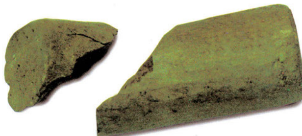
Φωτ. 4. Δείγμα αργίλου μετά από θραύση
