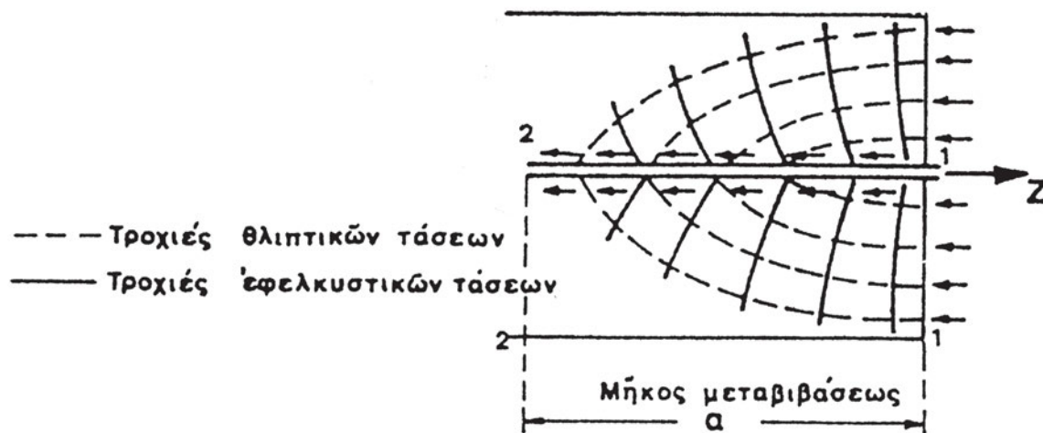
Σχήμα 16.1 Μεταβίβαση δυνάμεων κατά την εξόλκευση ράβδου οπλισμού.
