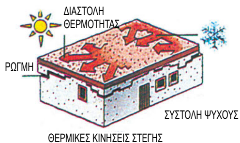
Σχήμα 8.13. Παραδείγματα θερμικών μεταβολών των δομικών στοιχείων.
