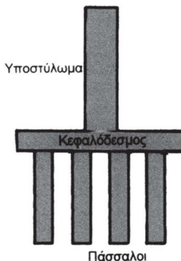
Σχήμα 5. Θεμελίωση υποστυλώματος με ομάδα πασσάλων.
