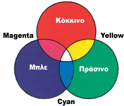
Εικόνα 4.11: Το κυανό, η ματζέντα και το κίτρινο είναι αφαιρετικά χρώματα. Αν τυπωθούν με πυκνότητα 100% το ένα επάνω στο άλλο, δίνουν, θεωρητικά τουλάχιστον, μαύρο χρώμα.
