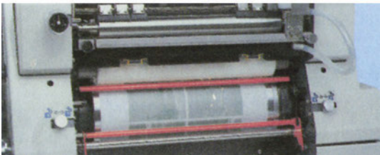
4.22 Αλουμινένιος τσίγκος εκτύπωσης, προσαρμοσμένος στον κύλινδρο της μηχανής
