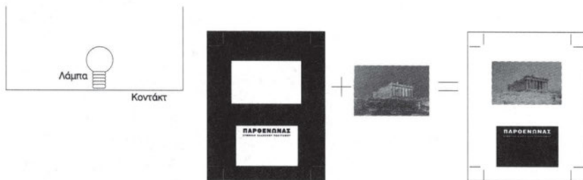
9.20 Σχηματική απεικόνιση που παρουσιάζει την ενσωμάτωση ενός τονικού αρνητικού θέματος από το χρωμογράφο και ενός γραμμικού αρνητικού από τη ρεπρόκάμερα σε ένα τελικό θετικό, στη διαδικασία της ένθεσης και με τη βοήθεια του κοντάκτ
