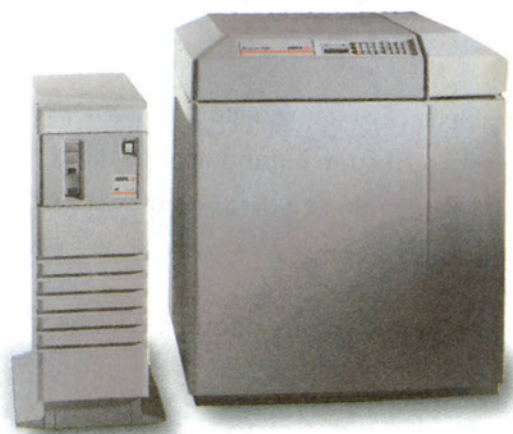
9.24 Εικονοθέτης συνοδευόμενος από υπολογιστή που αποκωδικοποιεί τη γλώσσα Postscript και καθοδηγεί την εγγραφή των φιλμ
