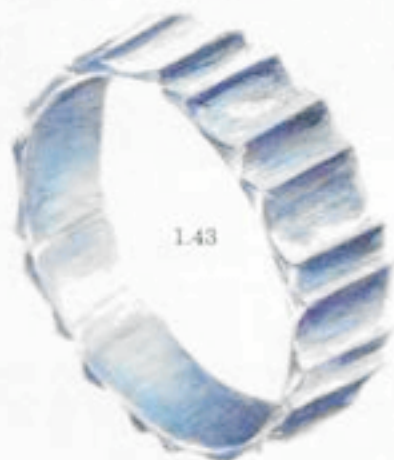
Εικ. 1.43 Αξονομετρικό σχέδιο βραχιολιού υπό κλίση 30^\circ/30^\circ .
