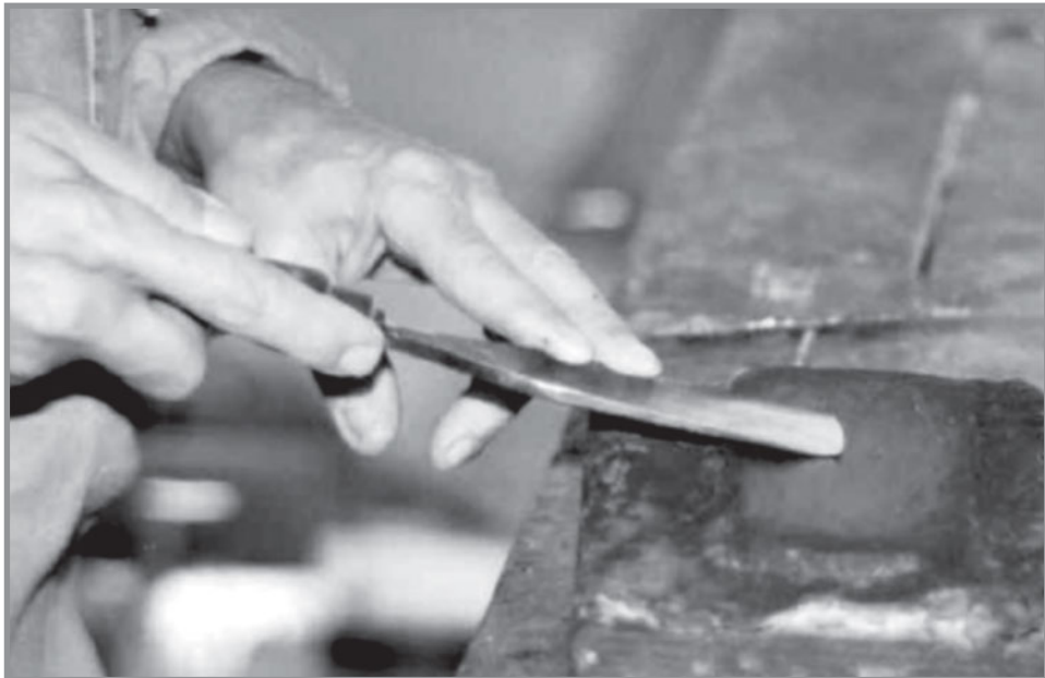
Εικ. 2.2. Ακόνισμα σγρόμπιας και ακριβής θέση χεριών
