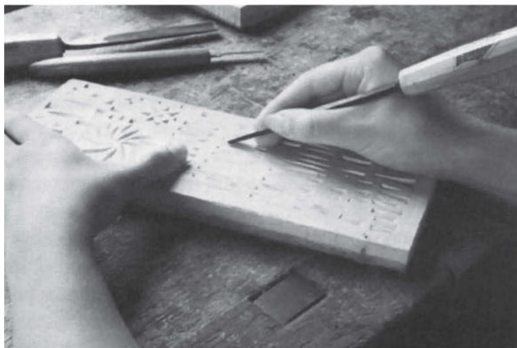
Εικ. 5.9. Εφαρμογή σκαρπέλων σε χάραγμα
