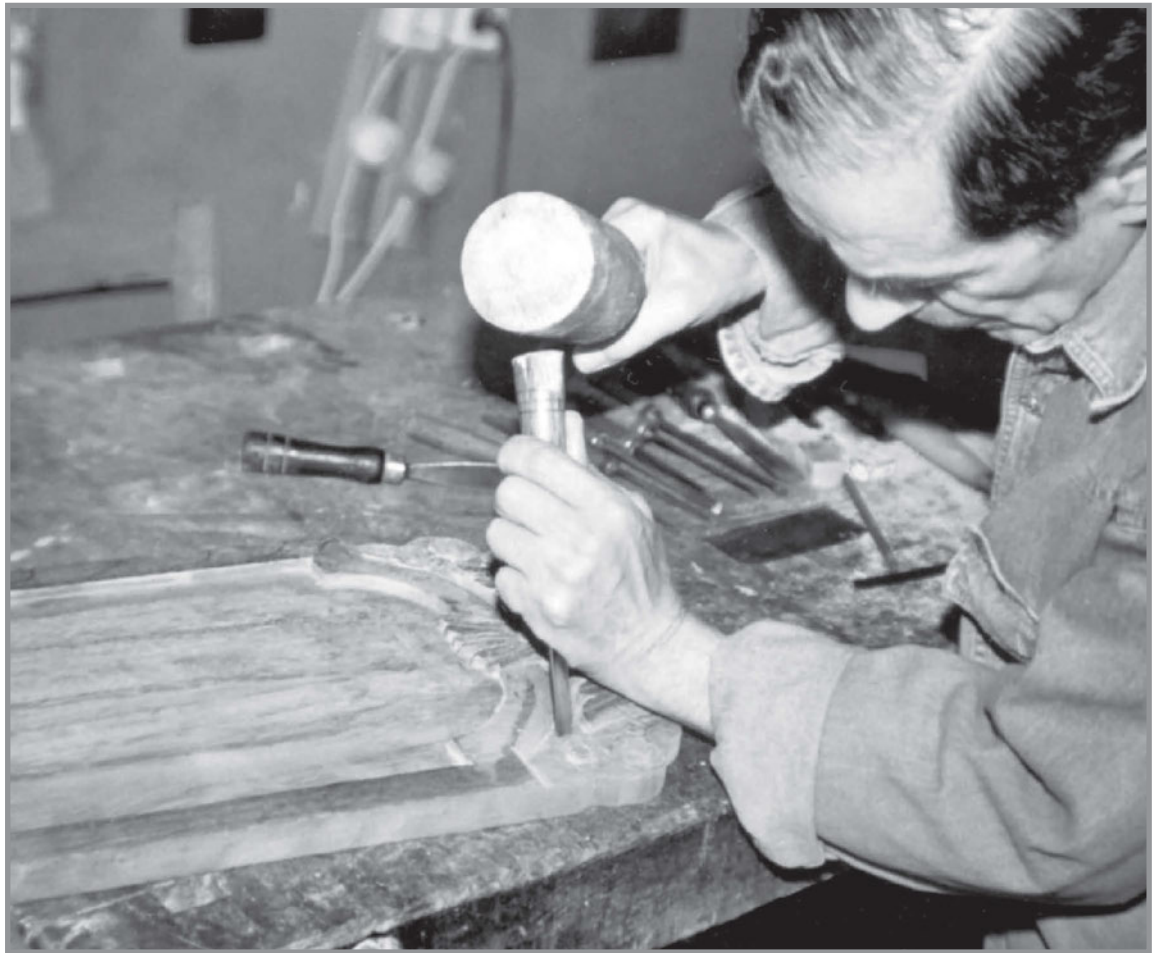
Εικ. 5.2. Τάκιασμα με σκαρπέλο και ματσόλα
