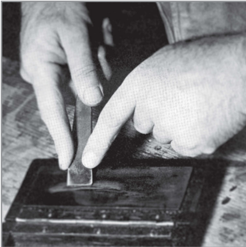
Εικ. 2.1. Ακόνισμα ίσιου σκαρπέλου σε ακόνι (λαδάκονο)
