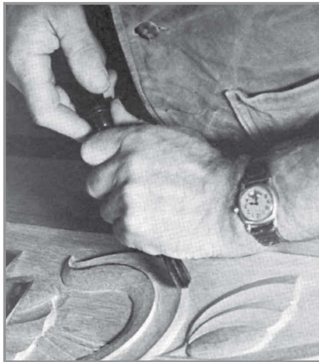
Εικ. 5.4. Τρόπος εργασίας με τρίγωνο σκαρπέλο
