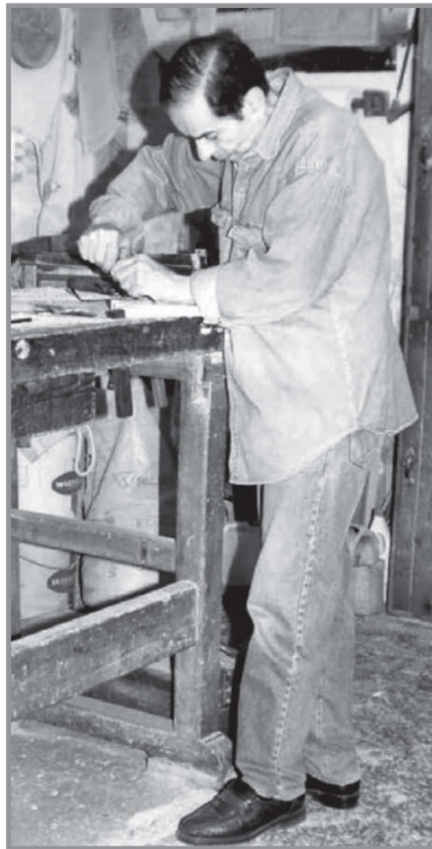
Εικ. 5.6. Θέση σώματος ξυλογλύπτη κατά το σκάλισμα
