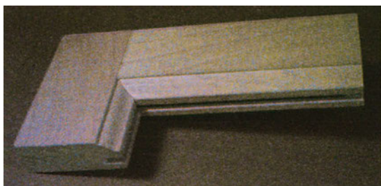
Εικ. 4.67., 4.68. Διαμόρφωση της εσωτερικής πλευράς του πλαισίου με διακοσμητικό «εργαλείο» (αριστερά). Με συμπληρωματικό εργαλείο διαμορφώνονται τα άκρα στα μόρσα, ώστε να επιτύχουμε τέλεια εφαρμογή των δυο στοιχείων (δεξιά).
