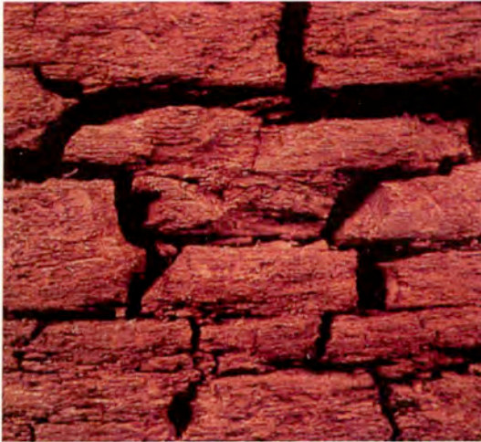
Εικόνα 2.1 Προσβολή ξύλου από διάφορα είδη μυκήτων.
