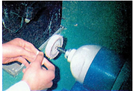
Εικόνα 11.3: Στίλβωση ολικής οδοντοστοιχίας στο ειδικό μηχάνημα (μοτέρ γυαλισματος)
