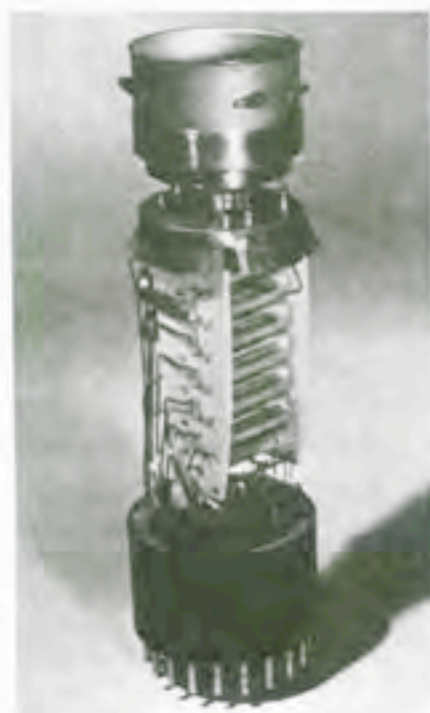
Σχ.2.6. Ο Ανιχνευτής σπινθηρισμών NaI με τον φωτοπολλαπλασιαστή του.
