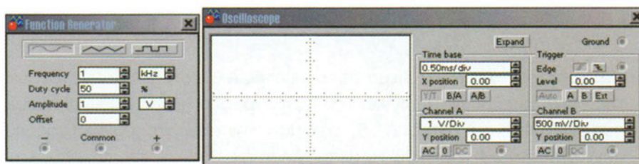
Σχ. Α.8.3. Ενδείξεις γεννήτριας συχνοτήτων και παλμογράφου
