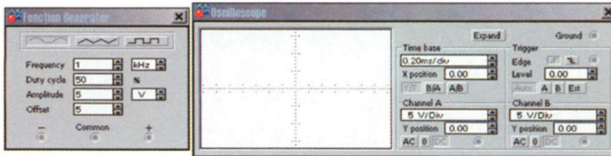
Σχ. A.5.4. Ενδείξεις γεννήτριας συχνοτήτων και παλμογράφου
