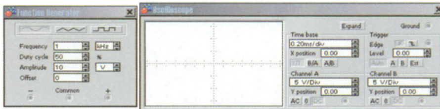
Σχ. A.5.5. Ενδείξεις γεννήτριας συχνοτήτων και παλμογράφου
