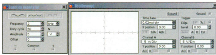
Σχ. Α.7.3. Ενδείξεις γεννήτριας συχνοτήτων και παλμογράφου
