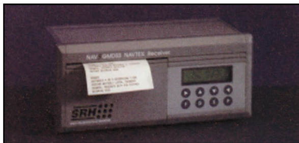
Φωτογραφία 17γ. Συσκευή NAVTEX
