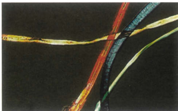
Εικόνα 4.18: Φωτογραφία από ίνες βαμβακιού σε μεγέθυνση. Η κόκκινη και η μπλε ίνα έχουν υποστεί μερσερισμό και φαίνονται διογκωμένες. Η πράσινη και η κίτρινη δεν έχουν και σε αυτές φαίνεται η χαρακτηριστική ταινιοειδής μορφή του βαμβακιού
