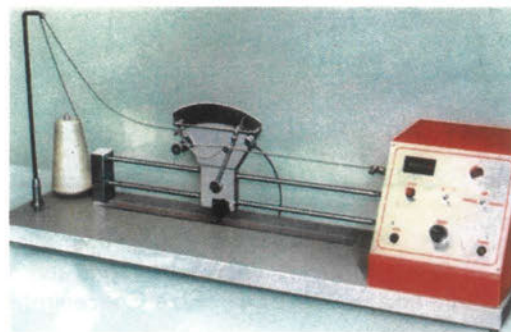
Εικόνα 2.12: Συσκευή για τον προσδιορισμό των στρίψεων των νημάτων (twist tester)
