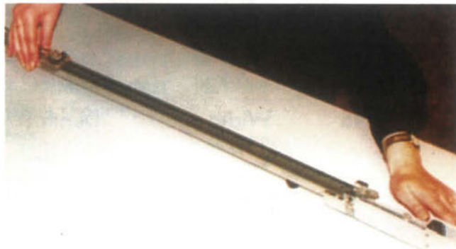
Εικόνα 2.24: Συσκευή μέτρησης μήκους νήματος υπό ορισμένη τάση -Crimp tester
