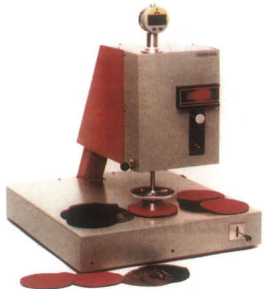
Εικόνα 2.19: Συσκευή προσδιορισμού του πάχους υφάσματος
