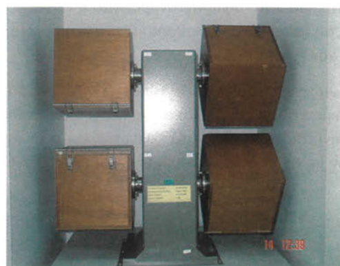
Εικόνα 3.19: Συσκευή I.C.I., για τον προσδιορισμό της αντοχής του υφάσματος στο «pilling»
