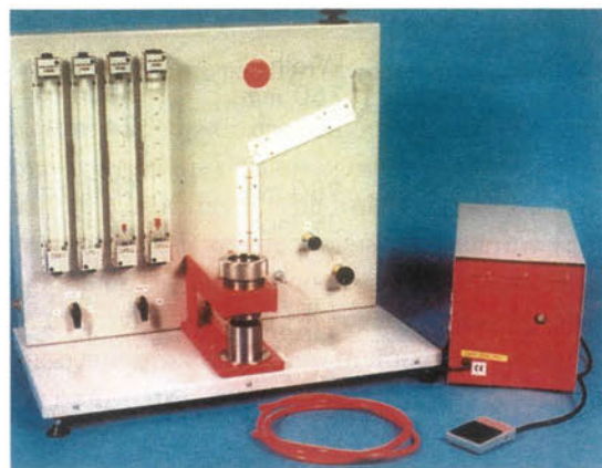
Εικόνα 3.13: Συσκευή προσδιορισμού της αεροδιαπερατότητας υφάσματος
