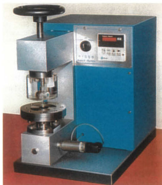
Εικόνα 3.16: Συσκευή προσδιορισμού της αντοχής του υφάσματος στη διάρρηξη (bursting strength tester)
