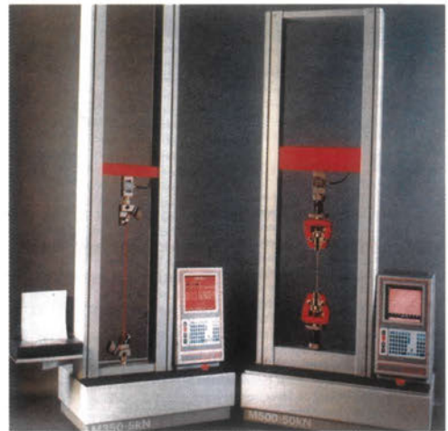
Εικόνα 2.13: Συσκευή προσδιορισμού της αντοχής του νήματος στον εφελκυσμό - Δυναμόμετρο
