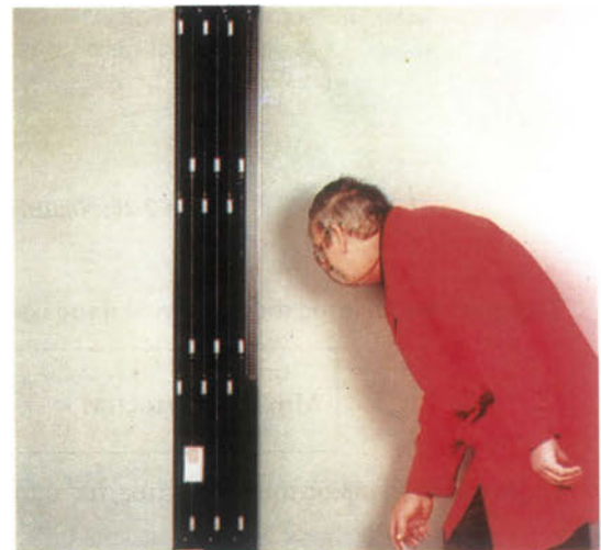
Εικόνα 2.25: Συσκευή μέτρησης μήκους νήματος σειράς πλεκτού υπό ορισμένη τάση
