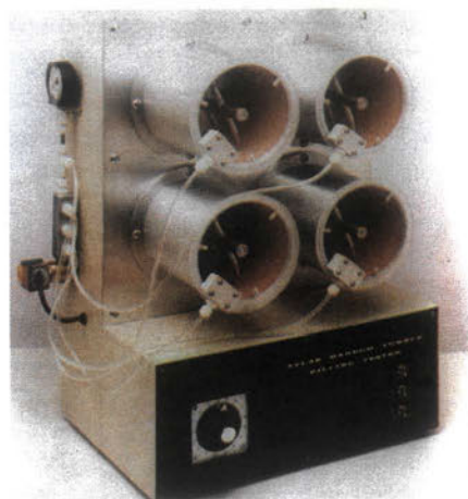
Εικόνα 3.6: Συσκευή Random Tumbler, για τον προσδιορισμό της αντοχής του υφάσματος στο «Pilling»
