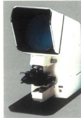
Εικόνα 2.10: Συσκευή μικροσκοπίου προβολής για τον προσδιορισμό του τύπου των ινών και των νημάτων
