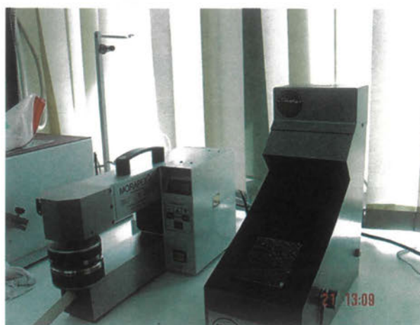
Εικόνα 3.21: Συσκευή οπτικής εκτίμησης του βαθμού «pilling» των δειγμάτων με φωτογραφικά πρότυπα
