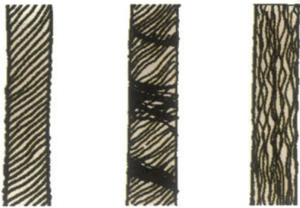
Εικόνα 2.9: α. Νήμα συμβατικής νηματοποίησης β. Νήμα ανοικτού άκρου με ρότορα γ. Νήμα τεξτουρέ
