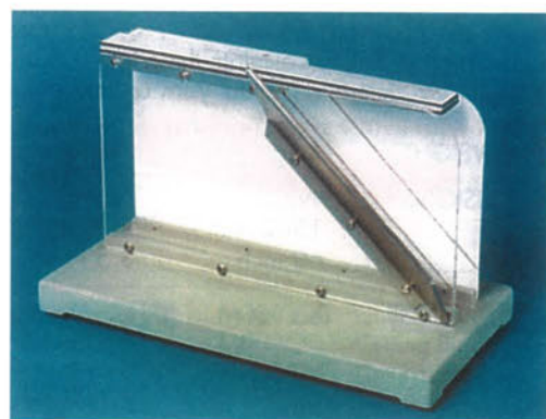
Εικόνα 3.9: Συσκευή προσδιορισμού της δυσκαμψίας και του πεσίματος του υφάσματος
