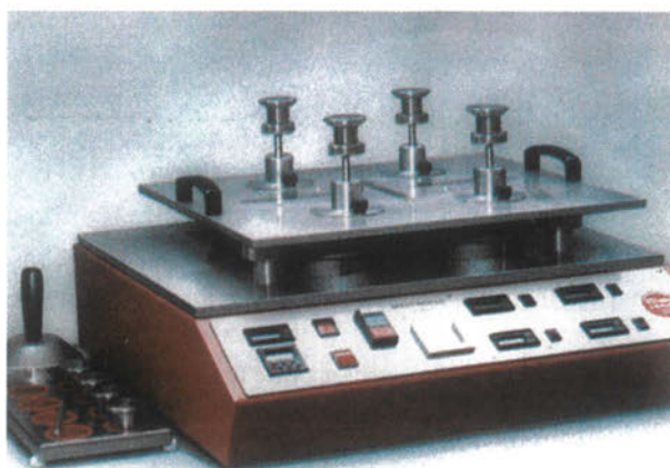
Εικόνα 3.20: Συσκευή Martindale για τον προσδιορισμό της αντοχής του υφάσματος στο «pilling»
