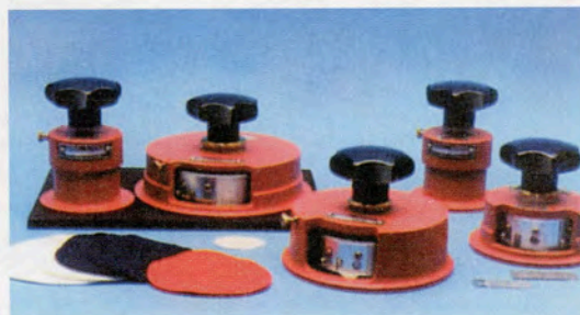
Εικόνα 2.6. Όργανα κοπής υφάσματος για τον προσδιορισμό του βάρους σε διαφορετικές διαστάσεις
