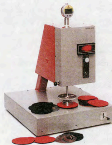
Εικόνα 2.5. Συσκευή προσδιορισμού του πάχους υφάσματος
