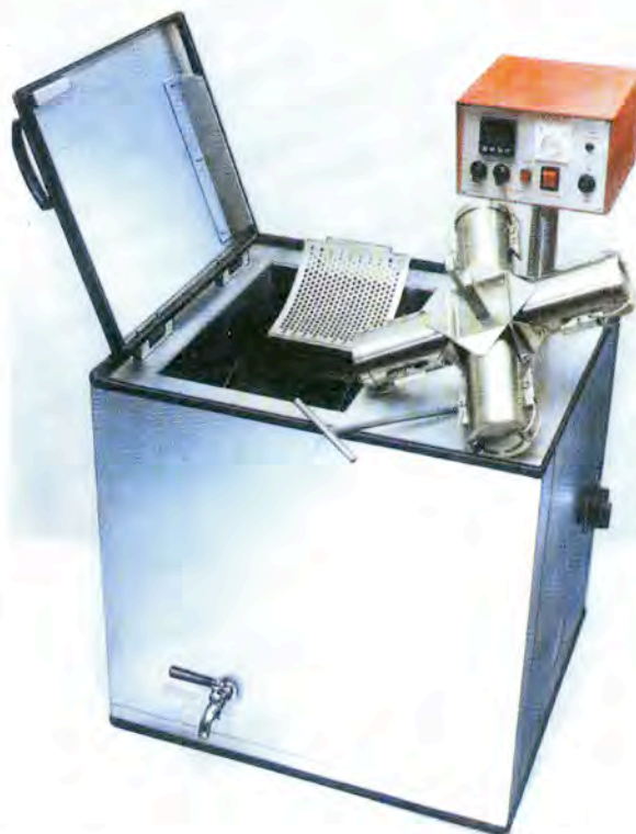
Εικόνα 4.1: Εργαστηριακό μηχάνημα για την εκτίμηση της αντοχής στο πλύσιμο (εργαστηριακό πλυντήριο)
