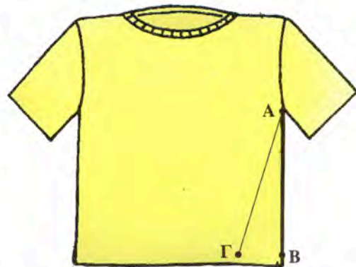
Εικόνα 3.11: Μέτρηση της συστροφής ραφής σε πλεκτό ρούχο
