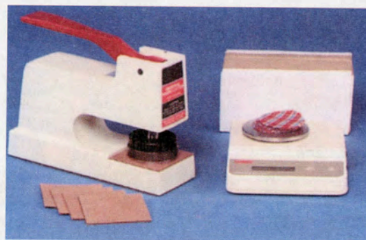
Εικόνα 2.7. Όργανο κοπής υφάσματος για τον προσδιορισμό του βάρους ανά μονάδα επιφάνειας και ηλεκτρονικός ζυγός
