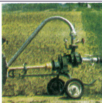
Σχήμα 13.3γ Φυγοκεντρική οριζόντια, ή υπό γωνία, τρακτεραντλία
