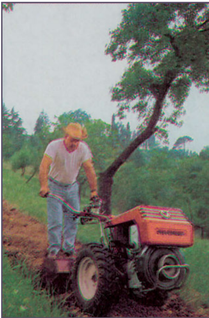
Σχήμα 9.4.1α Μονοαξονικός ελκυστήρας
