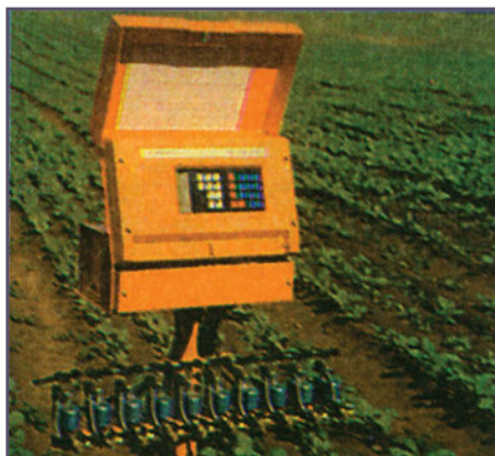
Σχήμα 14.5.1α Προγραμματιστής για αυτόματη λειτουργία
