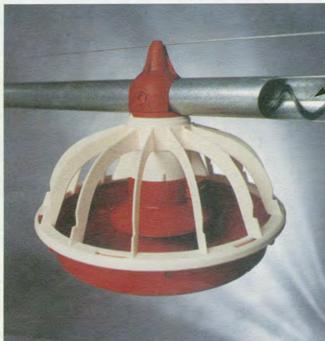
Εικόνα 5.10: Ταγίστρα σε αυτόματο σύστημα διανομής τροφής με κοχλία (βέλος) στο εσωτερικό του σωλήνα
