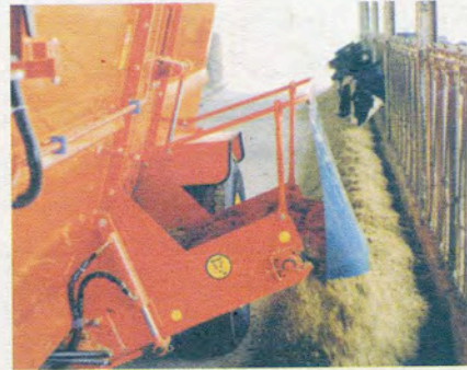
Εικόνα 5.7: (αριστερά) Αυτοκινούμενος αναμικτήρας που ανακατεύει ενσίρωμα με ΣΖ και (δεξιά) διανομή του μείγματος στις ταγίστρες
