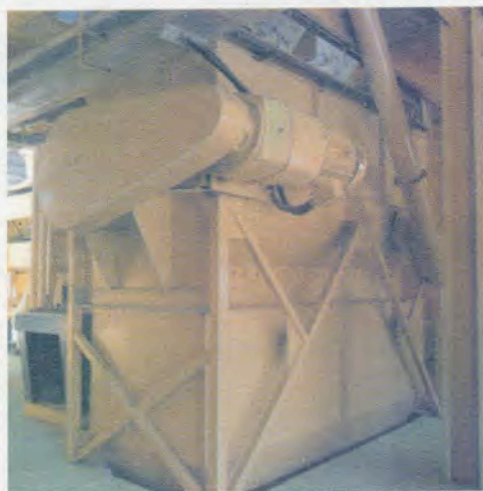
Εικόνα 3.4: Εξωτερικό (αριστερά) και εσωτερικό (δεξιά) ενός οριζόντιου αναμικτήρα
