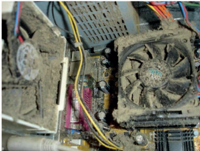
Σχ. 2.10 Η σκόνη αποτελεί σημαντική αιτία για την υπερθέρμανση του υπολογιστή
