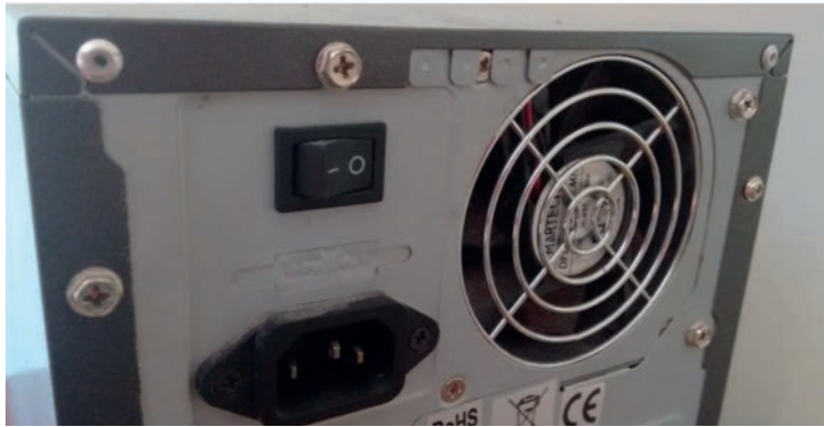
Σχ. 2.2 Διακόπτης τροφοδοσίας (κλειστός)
