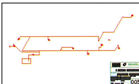
ΣΧ.10.2.5.α Σχέδιο κατακόρυφου πυροσβεστικού δικτύου.
