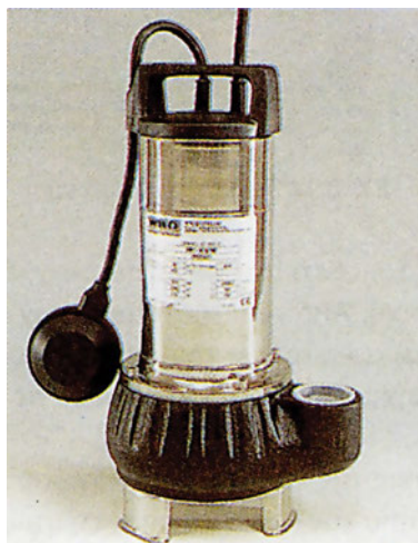
ΦΩΤ. 3.14.4.α Εμβαπτιζόμενη αντλία λυμάτων. Αριστερά διακρίνεται ο φλοτεροδιακόπτης, πάνω το καλώδιο ηλεκτροδότησης και κάτω δεξιά το στόμιο απομάκρυνσης των λυμάτων. Η αναρρόφηση γίνεται από το κάτω μέρος.
