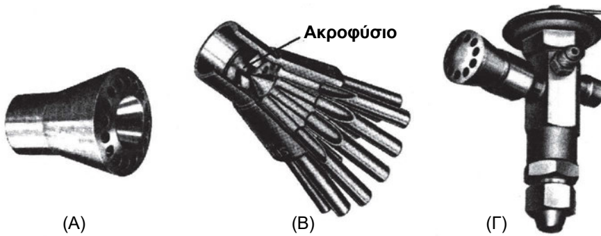
Σχήμα 8.8 Ο διανομέας του ψυκτικού ρευστού στα κυκλώματα: (Α) τυπική εξωτερική εμφάνιση, (Β) σε τομή, (Γ) τοποθετημένος απευθείας πάνω στη Θ.Ε.Β.
