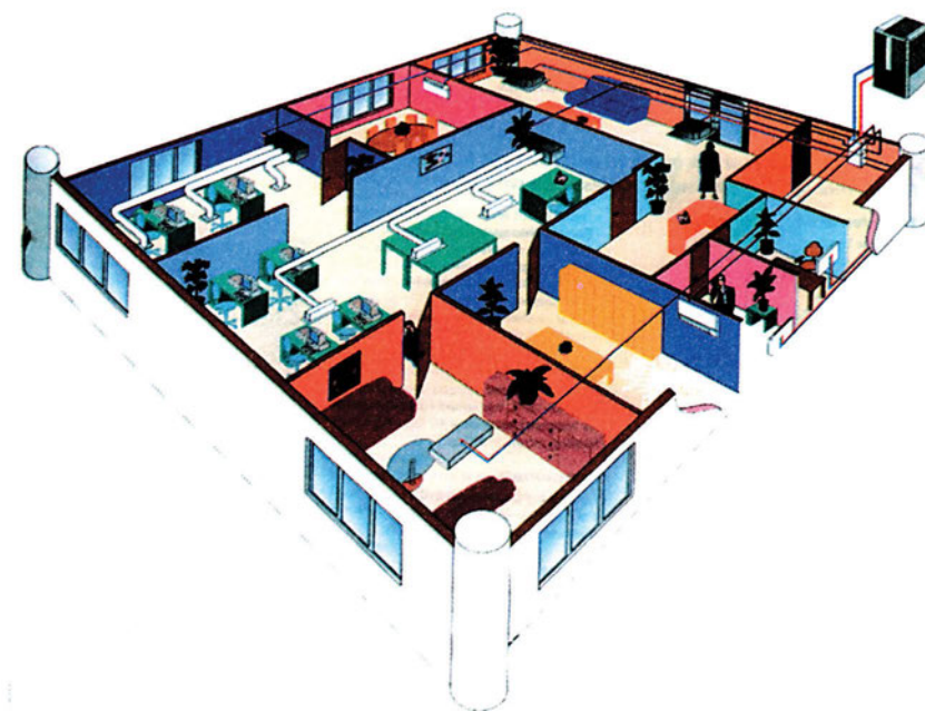
Εικόνα 5.4: Κεντρική εγκατάσταση κλιματισμού σε ένα μεγάλο χώρο γραφείων.
