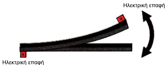
Σχήμα 2.58: Σχηματική παράσταση αρχής λειτουργίας διμεταλλικού ελάσματος.
