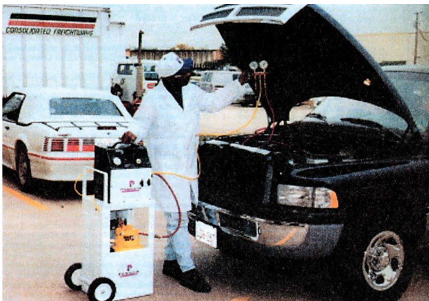
Εικόνα 6.2: Σύνδεση σερτ μονομέτρων στο σύστημα κλιματισμού.
