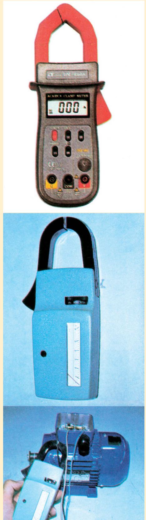
Μέτρηση της έντασης του ρεύματος με αμπεροτσιμπίδα
