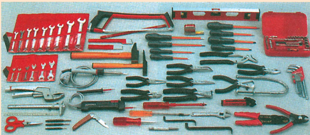
Φωτογραφία 2.3.2α: Τα εργαλεία του ηλεκτρολόγου εγκαταστάτη
