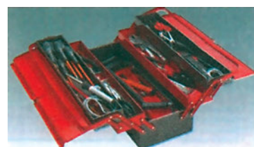
Φωτογραφία 2.3.1: Κασετίνα για εύκολη και ασφαλή μεταφορά των εργαλείων του ηλεκτρολόγου εγκαταστάτη
