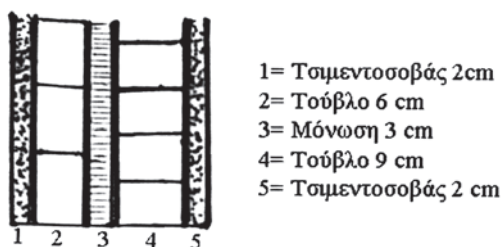
Εικ. 15.14 Τομή εξωτερικού τοιχώματος υποστασίου
