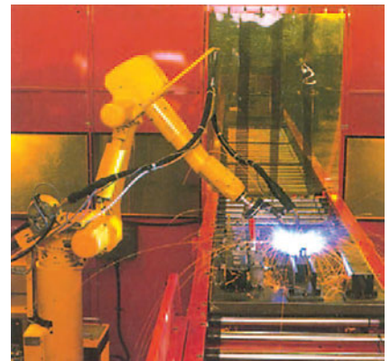
Εικ. 12 Βιομηχανικός ρομποτικός βραχίονας που χρησιμοποιείται για συγκόλληση.
