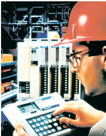
Εικ. 7 Υπολογιστής ελέγχου για τα αυτοματοποιημένα συστήματα παραγωγής και ελέγχου.
