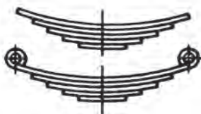
Εικ 7.6δ Ελατήρια πολλαπλών ελασμάτων
