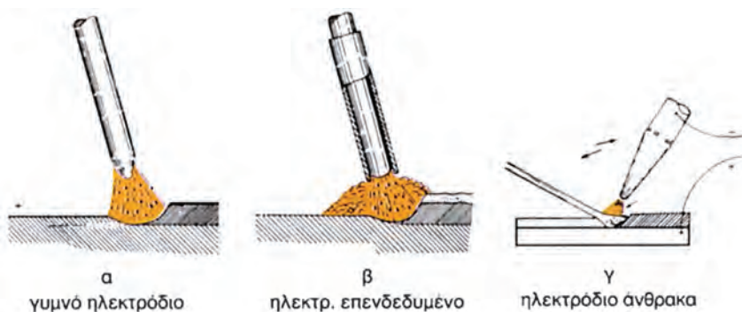
Εικ. 7.4β Συγκόλληση με ηλεκτρικό τόξο
