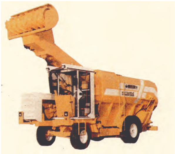
Εικόνα 10-30: Αυτοκινούμενο όχημα κοπής-ανάμιξης με σύστημα φόρτωσης ενσιρωμένων ζωοτροφών. Χαρακτηρίζεται από τη μεγάλη ευκολία στους χειρισμούς και την ευελιξία του κατά τη φάση της φόρτωσης. Μπορεί να φορτώνει και χύμα ζωοτροφές από σωρούς εξασφαλίζοντας ταυτόχρονα αξιόπιστες τιμές ζύγισης.
