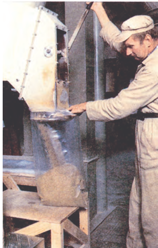
Εικόνα 10-32: Αυτόματο γέμισμα σάκκων με έτοιμο μίγμα
