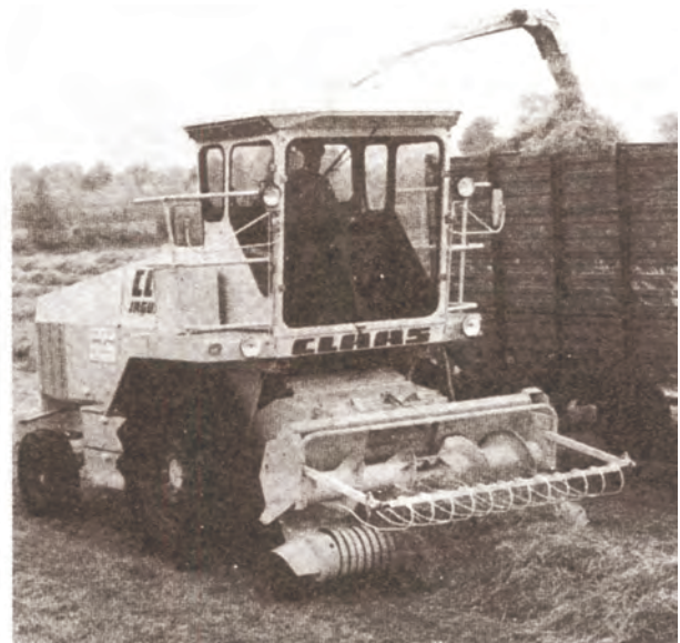
Εικόνα 10-20. Αυτοκίνητο μηχανήμα συλλογής και τεμαχισμού μαρανθείσας χλόης για ενσίρωση.
