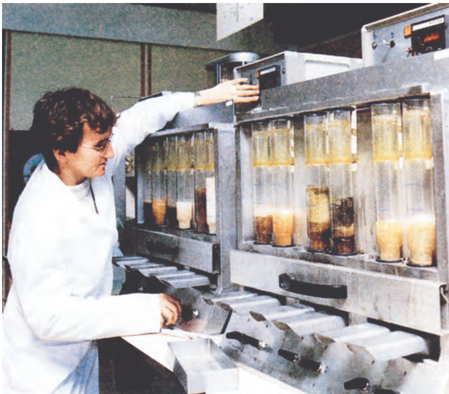
Εικόνα 10-1. Αυτόματη συσκευή προσδιορισμού κυτταρινών σε χονδροειδείς ζωοτροφές.
