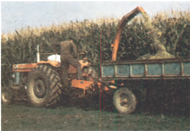
Εικόνα 10-19. Μηχάνημα συλλογής και τεμαχισμού αραβοσίτου για ενσίρωση.
