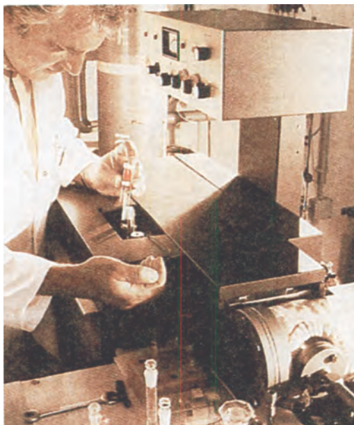
Εικόνα 10-2. Συσκευή χημικής ανάλυσης αίματος ζώων για έλεγχο της υγείας των
