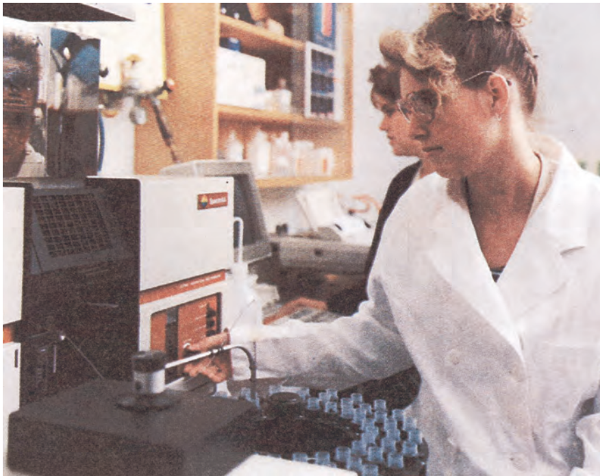
Εικόνα 10-3. Αυτόματη συσκευή προσδιορισμού ανόργανων στοιχείων σε ζωοτροφές
