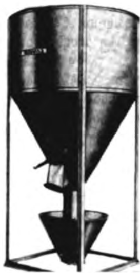
Εικόνα 10-25: Αναμικτήρας (χαρμανιέρα) ζωοτροφών (mixer)
