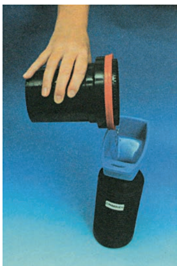
Φωτογραφία 4.20: Αδειάζουμε το εμφανιστικό υγρό στο δοχείο φύλαξής του
