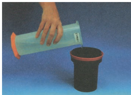
Φωτογραφία 4.22: Αδειάζουμε το διάλυμα της στερέωσης μέσα στο δοχείο εμφάνισης
