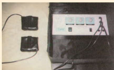
ΕΙΚΟΝΑ 10.3.α. Συσκευή μαγνητοθεραπείας με δύο πηνία διαστάσεων 12X12.
