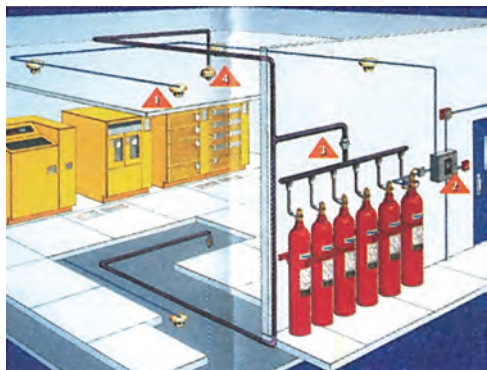
Εικόνα 1.10: Μόνιμα συστήματα με αλογονομένους υδρογονάνθρακες
