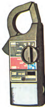
Σχ. 1.26: Αμπερομετρική πένσα (α) και χρήση της (β).
