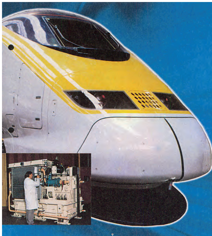
Σχ. 3.28: Η/Ζ με νηξελοκίνητηρα - 3~ εναλλακτήρα για σύγχρονο ηλεκτροκίνητο τρένο.
