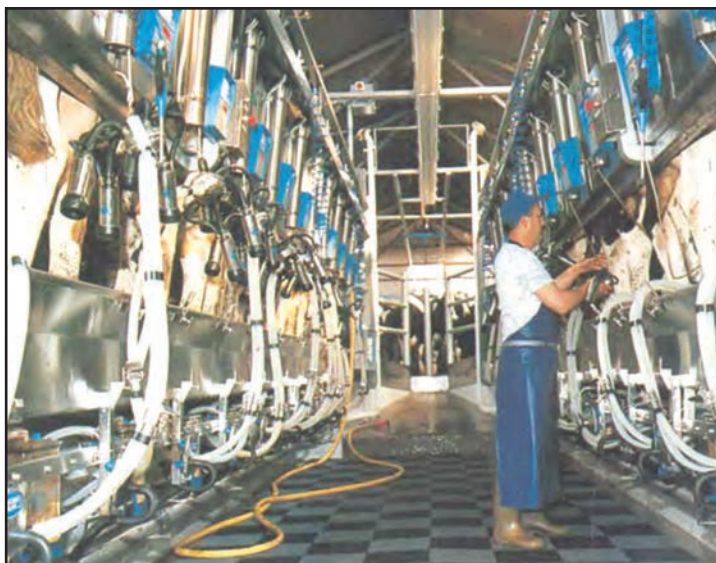
Εικόνα 6.72: Σύγχρονο αρμεκτήριο εξοπλισμένο με σύστημα αυτόματης απομάκρυνσης θηλάστρων, σύστημα μέτρησης της ποσότητας γάλακτος που παράγει κάθε αγελάδα και πίνακα λήψης πληροφοριών από τον υπολογιστή
