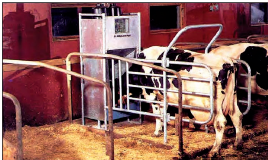
Εικόνα 6.71: Ηλεκτρονική ταΐστρα με σύστημα αναγνώρισης για αυτόματη ατομική διατροφή των αγελάδων σε σύστημα ελεύθερου σταυλισμού
