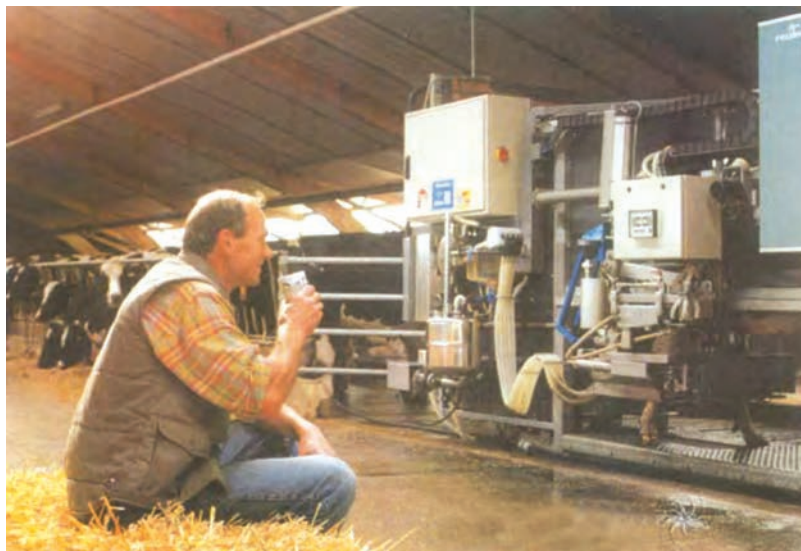
Εικόνα 4.6: Υπερσύγχρονο βουστάσιο εντατικής εκτροφής αγελάδων γαλακτοπαραγωγής με μονάδα «ρομποτικού αρμέγματος», όπου οι αγελάδες αρμέγονται όποτε αυτές θέλουν χωρίς την παρουσία αρμεκτή
