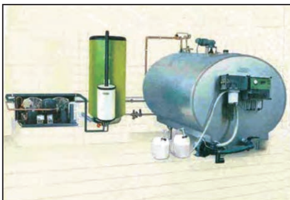
Εικόνα 6.55: Δεξαμενή ψύξης και διατήρησης του γάλακτος σε θερμοκρασία 2-4°C συνδεδεμένη με εναλλάκτη θερμότητας για την παραγωγή θερμού νερού από την ανακτηθείσα θερμότητα του γάλακτος
