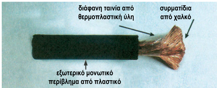
Φωτογραφία 6.3.2.γ Εύκαμπτο καλώδιο ηλεκτροσυγκολήσεων
