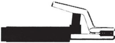
Σχήμα 8.4.2α: Λαβίδα συγκρατήσεως του ηλεκτροδίου (αρνητικός πόλος)
