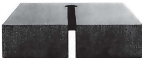
Σχήμα 6.5α Όψη τυπικής τομής με τη μέθοδο του πλάσματος
