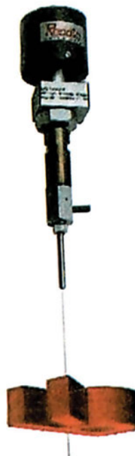
Σχήμα 6.5ε Κοπή με πίδακα νερού υψηλής πίεσης
