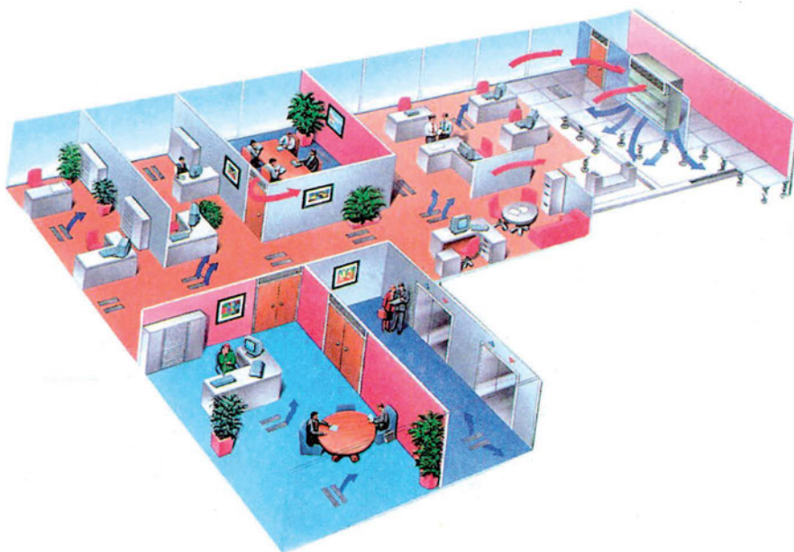
Σχήμα 8-67: Κλιματισμός συγκροτήματος γραφείων με μονάδα κλειστού κυκλώματος.
