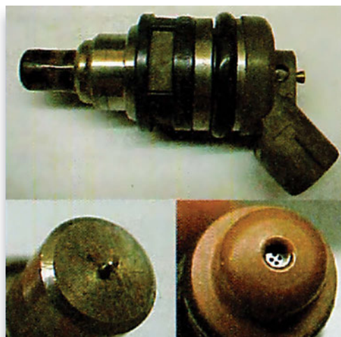
Σχήμα 7.11: Ηλεκτρομαγνητική βαλβίδα ψεκασμού καυσίμου (μπεκ). Η διαμόρφωση του καυσίμου σε μορφή ατμοποιημένου νέφους εξαρτάται όχι μόνο από τη μορφή και το σχήμα του στομίου της βαλβίδας αλλά και από τη συχνότητα ανοιγοκλεισίματος της βαλβίδας, δηλαδή από τη συχνότητα και τη διάρκεια των παλμών τάσης για το άνοιγμα της βαλβίδας.
