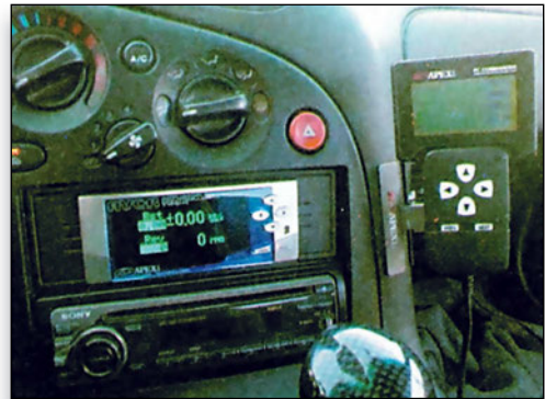
Σχήμα 7.27: Ενεργοποιητής απεικόνισης της πίεσης στην πολλαπλή εισαγωγή ενός συστήματος ενίσχυσης της ισχύος του κινητήρα (turbo). Η ερασιτεχνική αυτή εγκατάσταση και ρύθμιση του ενεργοποιητή απεικόνισης διαρκεί περίπου 5 ώρες και απαιτείται η πιστή τήρηση των οδηγιών του κατασκευαστή του για την τελική του ρύθμιση.
