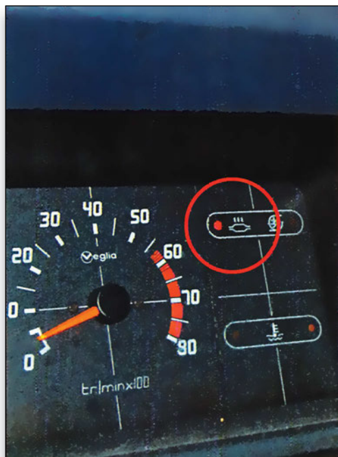
Σχήμα 8.5: Προειδοποιητική λυχνία για καταγραφή βλάβης (CHECK ENGINE).
