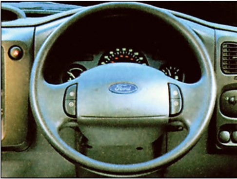
Σχήμα 7.29: Αλλαγή ταχυτήτων με διακόπτες τιμονιού σε αυτόματο κιβώτιο ταχυτήτων.
