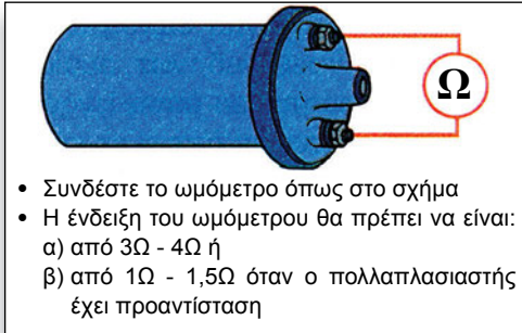
Σχήμα 9.30: Έλεγχος πρωτεύοντος πηνίου πολλαπλασιαστή.
