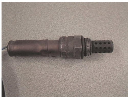
Σχήμα 6.50: Αισθητήρας λάμδα ( \lambda ) και καμπύλη τάσης εξόδου του.
