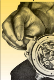
Σχήμα 8: Έλεγχος με φίλερ του διάκενου πλατινών.
