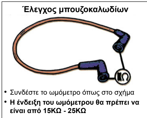
Σχήμα 10: Έλεγχος μπουζοκαλωδίων με ωμόμετρο.
