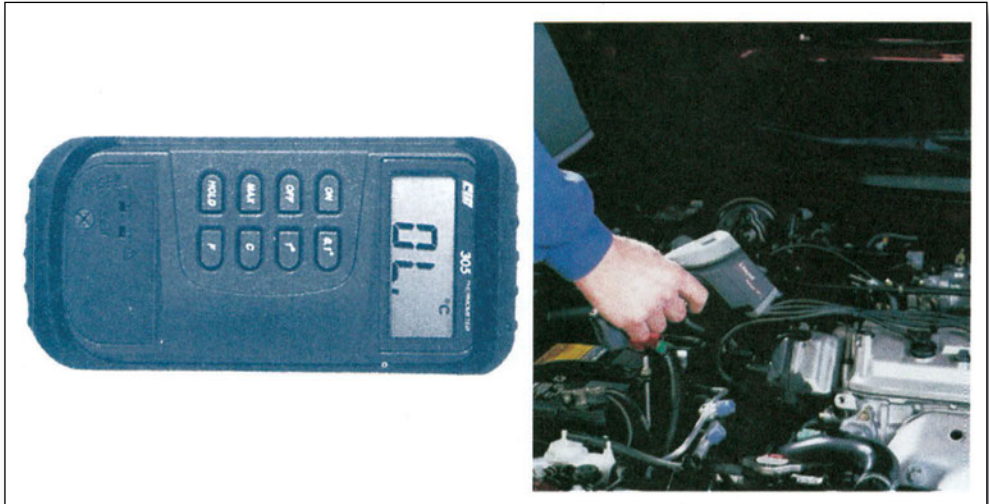
Σχήμα 12: Ψηφιακό θερμόμετρο και θερμόμετρα υπερύθρων ακτίνων.
