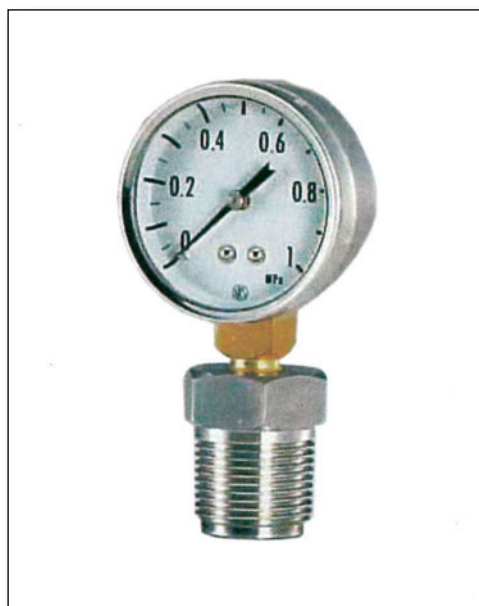
Σχήμα 11: Το υποπιεσόμετρο συναρμολογείται σε κατάλληλη υποδοχή της πολλαπλής εισαγωγής. Αν δεν υπάρχει υποδοχή, τότε συναρμολογήστε το στη θέση του αισθητήρα της υποπίεσης (MAP).
