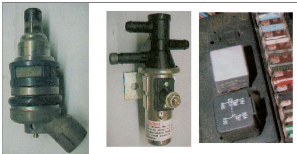
Σχήμα 3: Ηλεκτρομαγνητικές βαλβίδες και κιβώτιο ηλεκτρονόμων.
