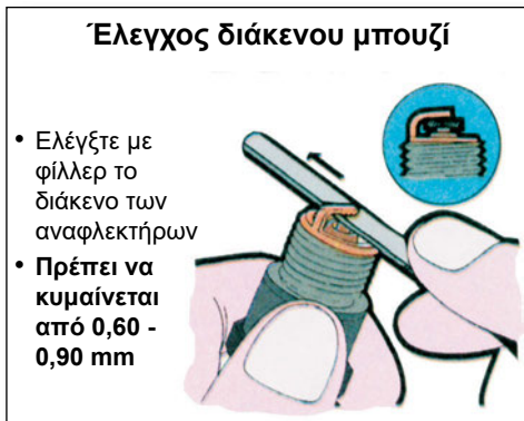
Σχήμα 11: Έλεγχος αναφλεκτήρων (μπουζί) με φίλλερ.
