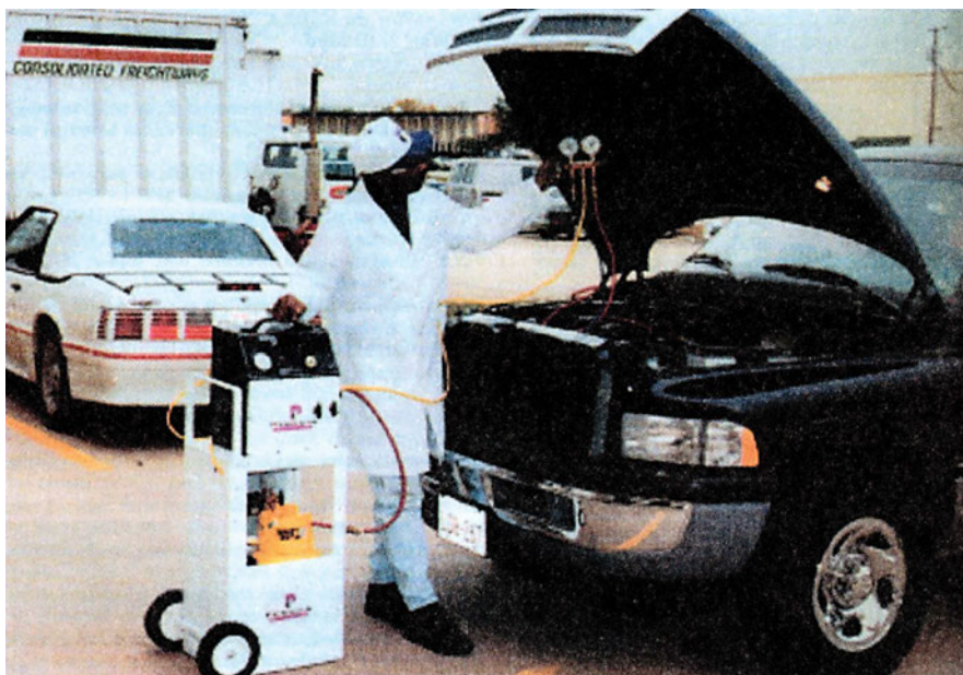
Εικόνα 6.2: Σύνδεση σελτ μανομέτρων στο σύστημα κλιματισμού.
