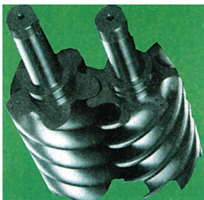
Εικόνα 2.1: Ζεύγος κοχλιόμορφων στροφείων σε συνεργασία.
