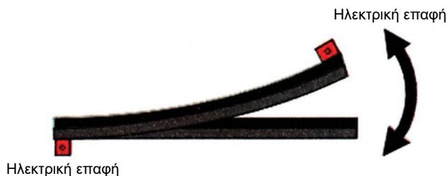
Σχήμα 2.58: Σχηματική παράσταση αρχής λειτουργίας διμεταλλικού ελάσματος.
