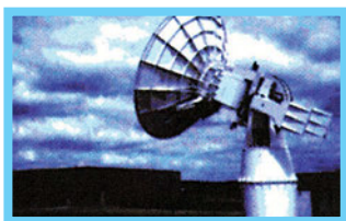
Σχήμα 8.4.3 Κεραία δορυφορικής λήψης του δικτύου Globalstar.
