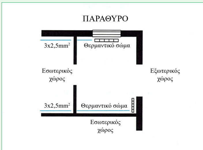
Σχήμα 2.3. Τοποθέτηση των θερμαντικών σωμάτων στην κάτοψη.
