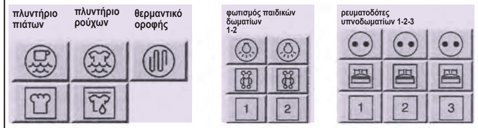
Εικόνα 7.4α: Παραδείγματα συστήματος σήμανσης των κυκλωμάτων
