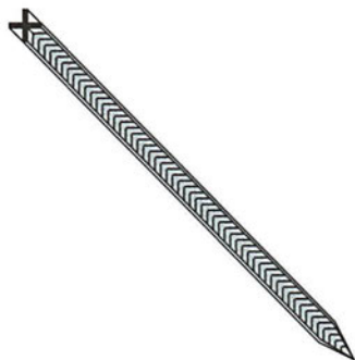
Χαλύβδινο επιψευδαργυρωμένο ηλεκτρόδιο διατομής σαυρού
