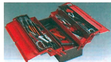
Φωτογραφία 2.3.1: Κασετίνα για εύκολη και ασφαλή μεταφορά των εργαλείων του ηλεκτρολόγου εγκαταστάτη
