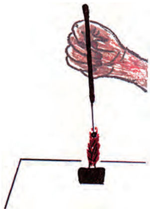
ΕΙΚΟΝΑ 7.3. ΣΧΗΜΑ 7.6. Πυράκτωση του κρίκου - στυλεού πάνω από φλόγα.
