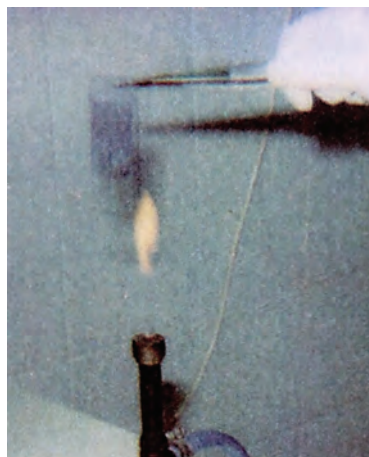
ΣΧΗΜΑ 7.8. - ΕΙΚΟΝΑ 7.12. Πέρασμα του πλακιδίου με το δείγμα πάνω από φλόγα.
