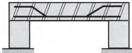
Σχήμα 10.45 Τοποθέτηση χάλυβα σε καμπτόμενη δοκό
