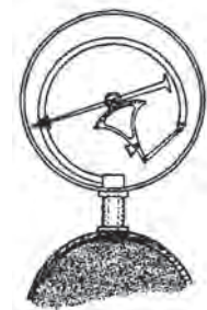
Σχήμα 15.8.ε Μεταλλικό μανόμετρο (Bourdon)
