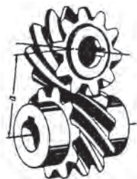
Σχήμα 13.7στ Ελικοειδείς οδοντωτοί τροχοί
