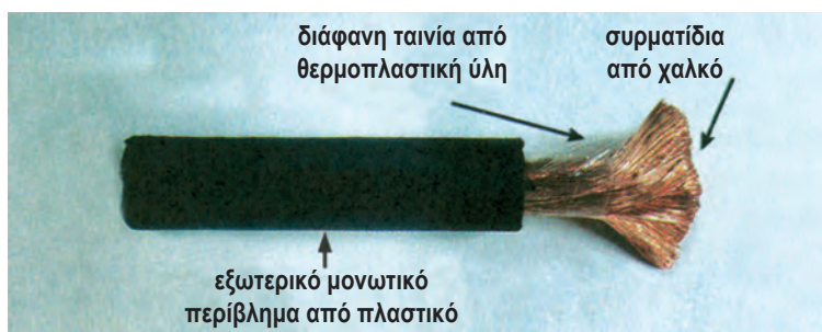
Φωτογραφία 6.3.2.γ Εύκαμπτο καλώδιο ηλεκτροσυγκολήσεων
