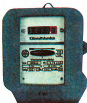
Σχήμα 3.4.γ Μετρητής ηλεκτρικής ενέργειας
