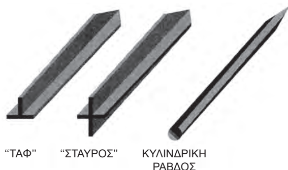
Σχήμα 7.4.3.γ Ραβδοειδή ηλεκτρόδια διαφόρων μορφών
