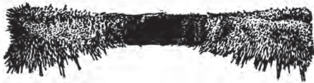
Σχήμα 5.1.α Αν πλησιάσουμε τον μαγνήτη σε ρινίσματα σιδήρου παρατηρούμε ότι στους δύο πόλους προσκολλώνται περισσότερα ρινίσματα, επειδή η ελκτική δύναμη είναι ισχυρότερη.
